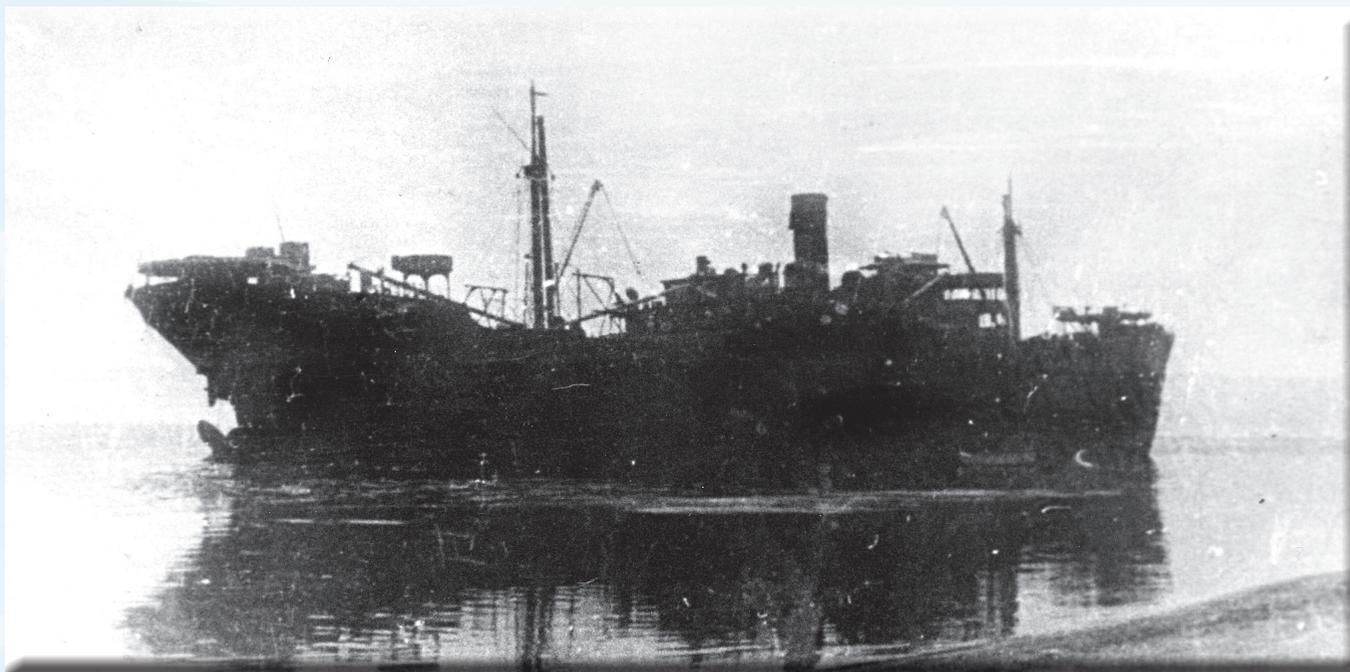
лодок и авиации. Имел вооружение и «De Soto» - на корме и носу поставили барбетты, на которых установили одно 102 мм и четыре 20 мм орудия, на мостике - четыре 12,7 мм зенитных пулемета.
